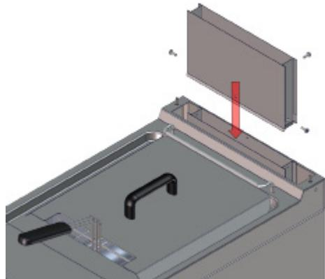
2) Plaats de moeren op de voorbereide schroeven, maar draai ze niet vast.
