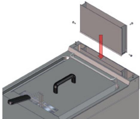
2) Placez les écrous sur les vis préparées, mais ne les serrez pas.
