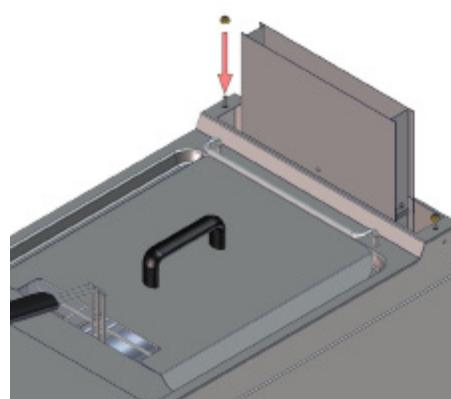
3) Bevestig de schoorsteen met moeren aan de voorbereide schroeven.
