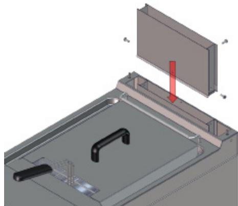
2) Setzen Sie die Muttern auf die vorbereiteten Schrauben, ziehen Sie diese jedoch nicht fest.
