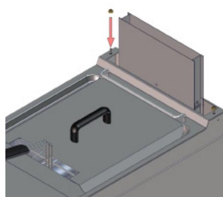
3) Befestigen Sie den Schornstein mit Muttern an den vorbereiteten Schrauben.
