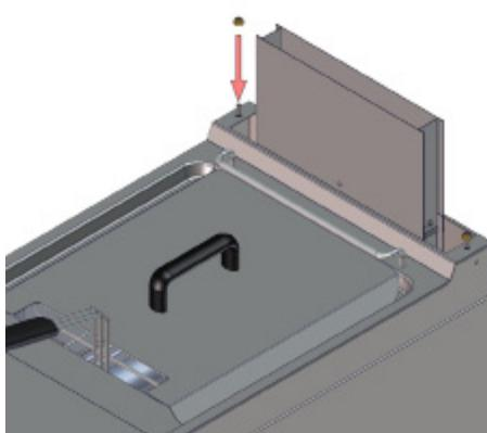
3) Monter la cheminée sur les vis préparées avec les écrous.
