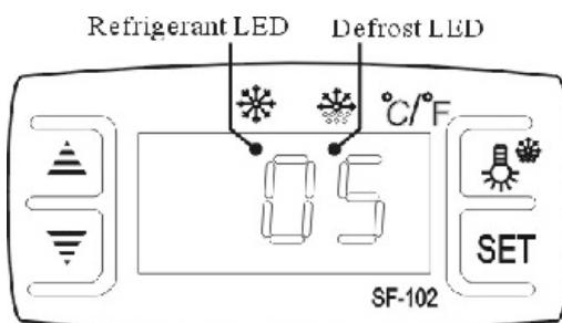
3. Temperatuur instellen: knop indrukken **SET**, wordt de ingestelde temperatuur weergegeven. druk op de knop **▲** of **▼** om de weergegeven waarde te wijzigen en op te slaan. druk op de knop **SET** om de instelling te verlaten en de koelkasttemperatuur weer te geven.
