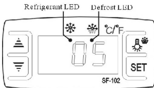
2. Temperatur einstellen: Taste drücken **SET**, die eingestellte Temperatur wird angezeigt. Drücke den Knopf **▲** Oder **▼** um den angezeigten Wert zu ändern und zu speichern. Drücke den Knopf **SET** um die Einstellung zu verlassen und die Kühlraumtemperatur anzuzeigen.
