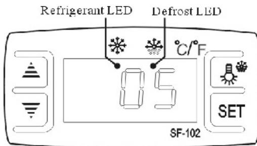
1. Régler la température : Appuyez sur le bouton **SET**, la température réglée s'affiche. Appuyez sur le bouton **▲** ou **▼** pour modifier et mémoriser la valeur affichée. Appuyez sur le bouton **SET** pour quitter le réglage et afficher la température de la chambre froide.
