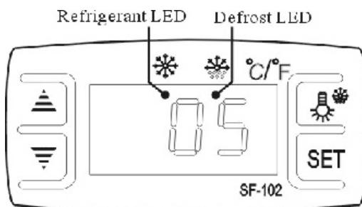
3. Temperatur einstellen: Taste drücken **SET**, die eingestellte Temperatur wird angezeigt. Drücke den Knopf **▲** Oder **▼** um den angezeigten Wert zu ändern und zu speichern. Drücke den Knopf **SET** um die Einstellung zu verlassen und die Kühlraumtemperatur anzuzeigen.
