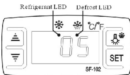
4. Ajustar la temperatura: Pulse el botón **SET**, se muestra la temperatura ajustada. Pulse el botón **▲** o **▼** para modificar y almacenar el valor mostrado. Pulse el botón **SET** para salir de la configuración y mostrar la temperatura de la habitación fría.
