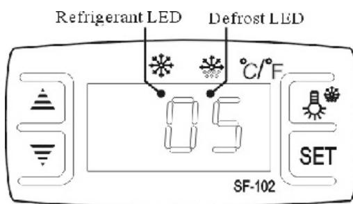
6. Temperatuur instellen: knop indrukken **SET**, wordt de ingestelde temperatuur weergegeven. druk op de knop **▲** of **▼** om de weergegeven waarde te wijzigen en op te slaan. druk op de knop **SET** om de instelling te verlaten en de koelkasttemperatuur weer te geven.
