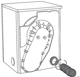
Les sorties latérales sont recouvertes d'un cache. L'appareil est livré avec une gaine d'évacuation (3) et deux colliers de serrage (2).
