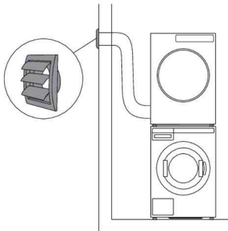
Si la gaine d'évacuation est raccordée à une ouverture dans un mur, vous pouvez éviter le reflux d'air froid en installant une grille d'aération.
