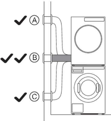
Placez l'appareil dans un local bien aéré comportant une fenêtre ou un ventilateur. Raccordez la gaine d'évacuation de façon à ce qu'elle ne soit pas inclinée vers le haut (A) ou vers le bas (C), mais reste autant que possible à l'horizontale.
